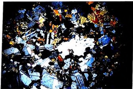
Mikroskop altında suxur şiflları: qabbro- diorit (solda) və qabbro.
